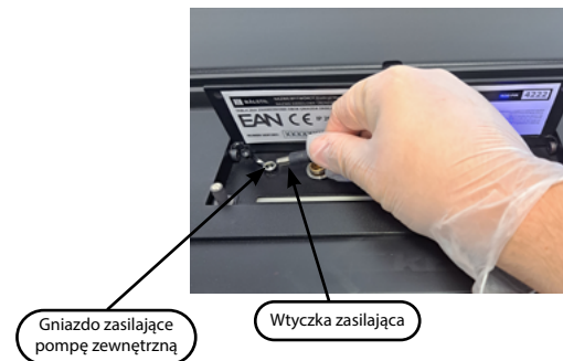
Rys. 9-58 Podłączenie zasilania pompy zewnętrznej
