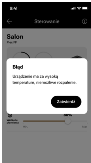
Abb. 9-44 Meldung über den Versuch, ein Gerät zu starten, das noch nicht abgekühlt ist
