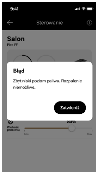
Rys. 9-45 Komunikat o próbie rozpalenia urządzenia, gdzie znajduje się za mało paliwa w zbiorniku
