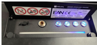
Rys. 9-54 Wskazanie około 5% paliwa w zbiorniku.
