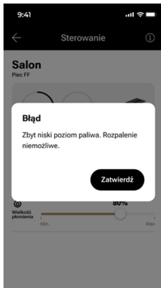
Abb. 9-45 Meldung über den Versuch, das Gerät zu zünden, wenn zu wenig Kraftstoff im Tank ist
