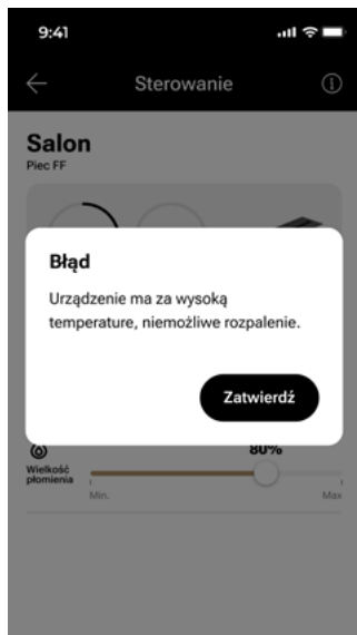
Rys. 9-44 Komunikat o próbie rozpalenia urządzenia, które jeszcze nie ostygło
