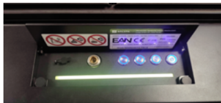
Abb. 9-52 LED-Streifen während des Zündvorgangs des Geräts
