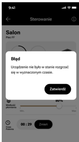
Rys. 9-46 Komunikat o prawdopodobnej awarii grzałek bloku grzewczego
