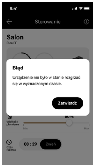
Abb. 9-46 Meldung über einen wahrscheinlichen Ausfall der Heizblockheizungen
