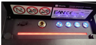
Abb. 9-55 LED-Streifen nach Erkennung der nicht erfüllten Sicherheitsbedingungen
