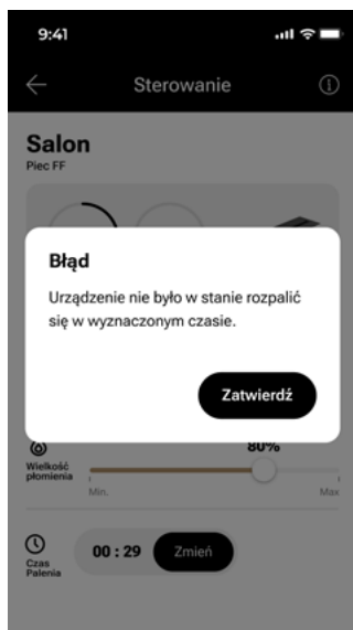
Rys. 9-47 Komunikat o prawdopodobnej awarii pręta zapłonowego
