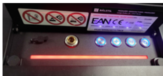
Rys. 9-55 Pasek LED po wykryciu niespełnionych warunków bezpieczeństwa
